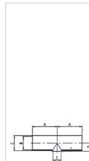
T-Stück DIN-SSS-kurz-red., Art. 5227 • Wst. 1.4301 poliert
