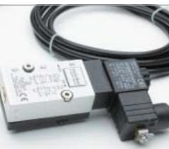
**Magnetventil NAMUR Art. MV53/2ex** • mit kombinierter 5/2- und 5/3- Wege Funktion, mit explosionsgeschützter Spule (ZONE 1) EX II 2G, 2D EEx m II T5 mit vergossenem Kabel 3 m lang
