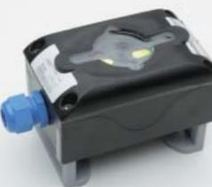
**Endschalterbox Art. Endschaft-I-Ex** • aus Polyamid, gemäß VDI/VDE 3845, IP 67, mit 2 ex-eigensicheren induktiven Näherungsschaltern, 2- Draht, Typ P + F NJ2-V3-N / ATEX
