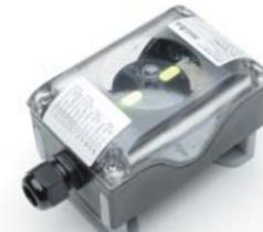
**Endschalterbox Art. Endschaft-I** • aus Polyamid, gemäß VDI/VDE 3845, IP 67 mit 2 induktiven Näherungsschaltern, 3-Draht, Typ P + F, NBB2-V3-E2
