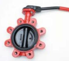
**Absperrklappen mit Anflanschgehäuse Art.LUG3N** • Scheibe GGG 40 epoxyb., Manschette NITRIL, inkl. Handhebel
