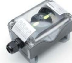
**Endschalterbox Art. Endschaft-M** • aus Polyamid, gemäß VDI/VDE 3845, IP 67 mit 2 mech. Endschaltern Typ Cherry, D44X
