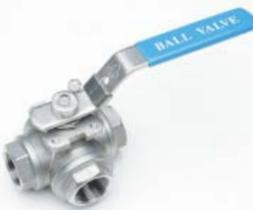
**3-Wege-Edelstahl-Kugelhahn Art. TB401** • PN 50, reduzierter Durchgang, mit Innengewinde, L- oder T-Bohrung, 4-seitig gedichtet, ISO-Flansch
