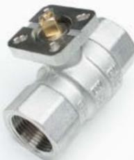
**Messing-Kugelhahn Art. S1021** • 2-teilig, PN 40, voller Durchgang für Antriebsdirektbau
