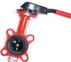
**Zwischenflansch-Absperrklappen Art.KL3E** • geb. PN 6-16, Scheibe GGG40 epoxybeschichtet, Manschette EPDM, inkl. Handhebel
