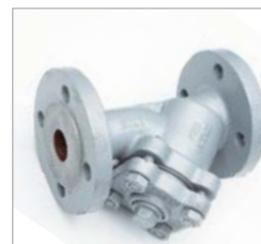
Flanschen - Schmutzfänger Art. 8496 • aus Grauguss GG25, MW: DN15 und DN20 0,5mm; DN25-65 0,75mm, DN80-200 1,2mm
