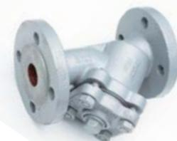
**Flanschen - Schmutzfänger Art. 849F** • aus Grauguss GG25, mit Doppel Feinsieb Maschenweite 0,25mm
