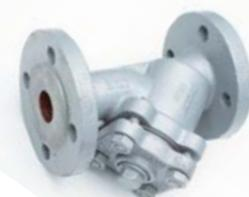
**Flanschen - Schmutzfänger Art. 8496** • aus Grauguss GG25, MW: DN15 und DN20 0,5mm; DN25-65 0,75mm, DN80-200 1,2mm
