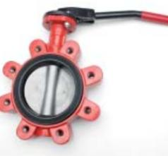
**Absperrklappen mit Anflanschgehäuse Art.LUG5E** • Scheibe 1.4408, Manschette EPDM, inkl. Handhebel
